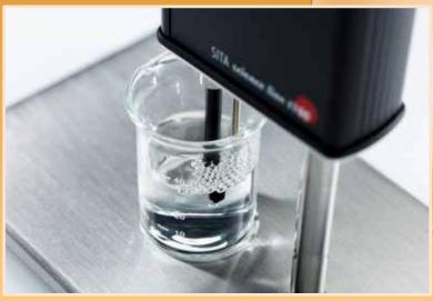
SITA 的气泡压力法测量动态表面张力具有高精确性和灵活性且无需调整毛细管的浸没深度。这是依靠微气泵通过毛细管向液体中鼓泡来达成分析的。 此过程中,气泡中的
